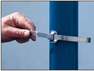
Schlaufe mit den Ohren zum Bandende auf das Band ziehen. Schelle formen und Band auf Band legen. Schlaufe über beide Bänder ziehen und das Bandende ca. 30 mm unter die Schlaufe biegen. Bei hoher Belastung der Schelle (z. B. bei Schlaucheinbindung) Band zweimal durch die Schlaufe ziehen.
