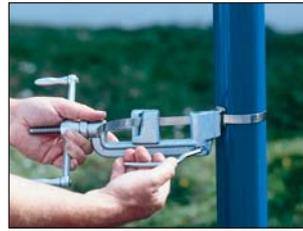
Nach Erreichen der erforderlichen Spannung das Werkzeug langsam über die Schlaufe biegen. Dabei gleichzeitig die Kurbel ca. eine halbe Umdrehung lösen, um Spannungsverlust und Reißen des Bands zu vermeiden. Um das Band abzuschneiden, Schneidhebel ruckartig ziehen und das abgeschnittene Bandende mit dem Daumen andrücken.
