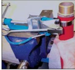
Stecken Sie den Schlauch durch die Schelle und drehen die Kurbel des Spannwerkzeuges nach rechts bis die gewünschte Spannung erreicht ist. Wenn sich das Band nicht mehr durch die Schlaufe zieht, ist die maximale Zugkraft erreicht. Die Bewegung des Bandes kann leicht durch Auflegen des Fingers „erfühl“ werden.
