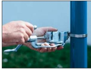
Band in das Spannwerkzeug seitlich einführen, Excenterhebel andrücken und durch Drehen der Kurbel Schelle anziehen. Die maximal Spannung ist erreicht, wenn das Band nicht mehr unter der Schlaufe durchzieht (läßt sich durch Auflegen eines Fingers leicht „erfühlen“).
