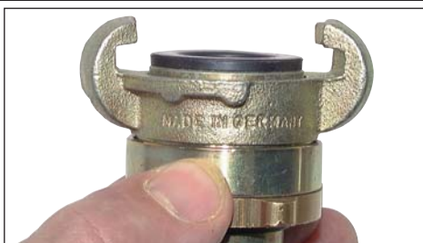
Vorgeschraubte Dichtung - Verbindung ist dicht.
