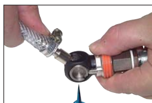
Kupplung ausschwenken - Kupplung schließt und entlüftet
