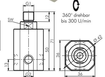
360° drehbar bis 300 U/min
