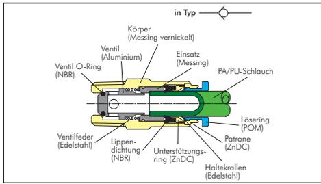
**Funktionsprinzip:** Die Rückschlagventile verhindern einen Rückfluss des Luftstromes.
