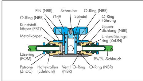
**Funktionsprinzip:** Die Absperrhähne sperren den Luftstrom ab und trennen damit 2 Systeme voneinander, ohne eine Seite zu entlüften.
