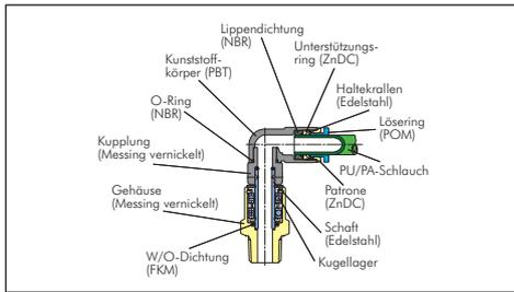
**Funktionsprinzip:** Die Drehverschraubungen (mit zwei Kugellagern) können eingesetzt werden, wenn ein Luftstrom in eine schnelldrehende Welle geführt werden soll.
